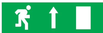
Направление к эвакуационному выходу прямо (E 11)
